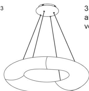
3. Upravte výšku jednotlivých laničk závesu tak, aby bolo svietidlo v požadovanej výške a vo vodorovnej polohe
